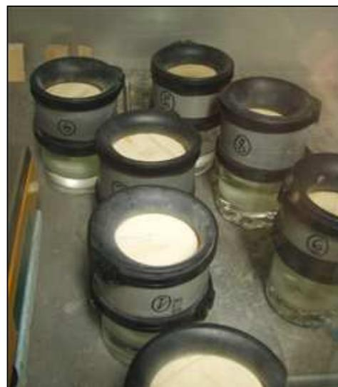
Figure 3. Dispositifs PVC-CHA placés dans l'enceinte climatique.
